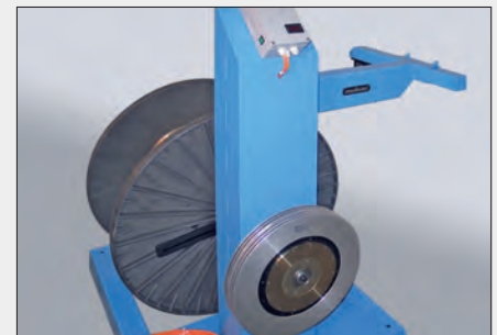
Zugregelung an einem Drahtabwickler Tension control on a wire payoff
