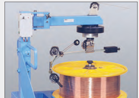
Drahtzugregelung an einem Abwickelflyer Wire tension control on a flyer payoff
