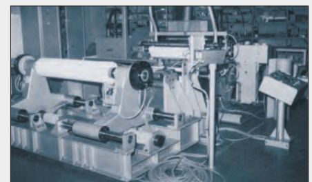
Zugregelung an einer Folienabrollmaschine Tension control for foil payoff
