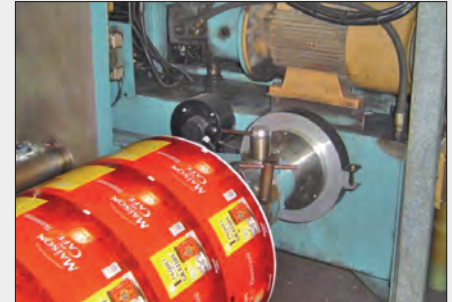
Zugregelung einer Stempelschneidmaschine Closed loop tension control & regulation on a die cutting machine
