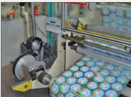
Zugkraftsteuerung der Folien Abwickelstation follower arm diameter measurement on an unwinding station
