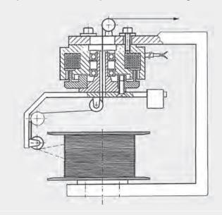
Anwendung von Hysteresebremsen bei der Simulierung von Drehmomenten für z.B. Lebensdauertests von Elektromotoren, Getrieben und vielen anderen rotierenden Einheiten und Anlagen.
