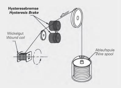
Anwendungsbeispiel einer Hysteresebremse mit großer Bohrung: Die Einheit ist verbunden mit einem Abwickelflyer um Drähte überkopf zuggeregelt von Spulen abzuziehen.
