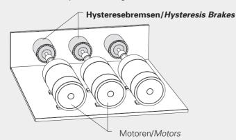
Unabhängig von der Regelart (Tänzerrolle, Tastarm, Fotozelle oder Ultraschall-Sensor) werden Hysteresebremsen stets als beste Lösung für eine Zugregelung eingesetzt.
