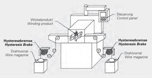
Bei Spulen- und Transformatorwickelmaschinen werden Hysteresebremsen eingesetzt, um eine genaue Zugregelung während des Wickelprozesses zu gewährleisten.
